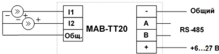
Рис.4. Схема подключения модуля аналогового ввода МАВ-ТТ20.
