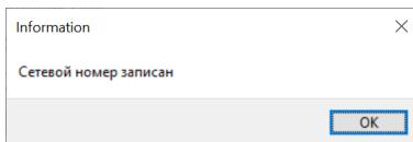
Для проверки связи с преобразователем с известным сетевым номером введите этот номер в поле «Сетевой номер» и нажмите кнопку «Установить связь». В случае успешной установки связи, программа выведет информационное сообщение:
