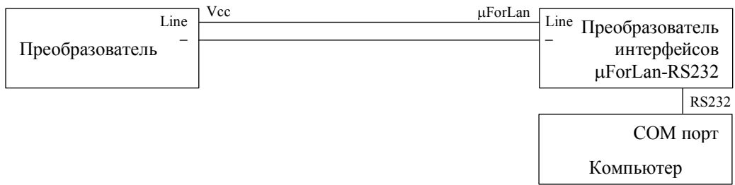
Рисунок 5 – Схема подключения преобразователя исполнения ДВ2ТСМ (кроме 4П и АК) (с интерфейсом \mu ForLan).
